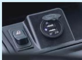
カート電源操作パネルに配置されたシートヒータースイッチ。冬季の居住性に嬉しい機能だ。
