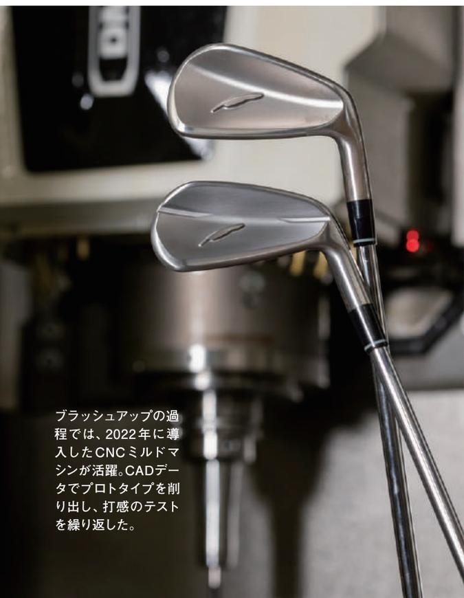
ブラッシュアップの過程では、2022年に導入したCNCミルドマシンが活躍。CADデータでプロトタイプを削り出し、打感のテストを繰り返した。
