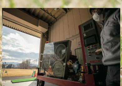
「ファンチャー」というテストマシンで飛びの三要素の初期条件を設定し、弾道の飛翔状態からデインプルの性能を追求している。
